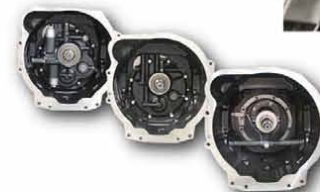
Tres opciones de transmisión: 8x8 con inversor mecánico, 8x8 con inversor hidráulico y 16x8 con inversor hidráulico Adicionalmente el Creep
